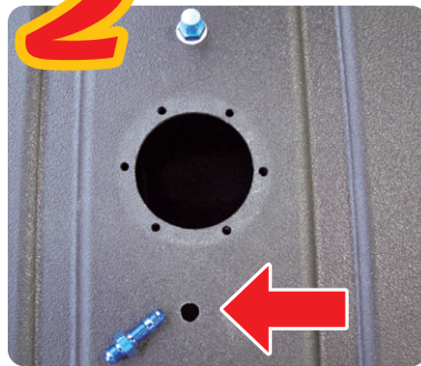
スポンジフォーム をタンクから取外し、タンク上面に フューエル取り出しのための穴を 開ける
