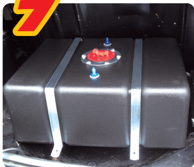
トランクルーム内 レイアウト図 (下部取り出し口を車 輛前側にし、確実に 固定すること) ※内圧膨張防止プリー ザーホースは必ず取 り付け、ホースエン ドは車外に出すこと
